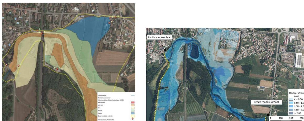
Application d'une meilleure approche hydrologique à la reconstitution des zonages de crue. Figure de gauche : Zonage identifié post crue (Ligne jaune) superposé au zonage réglementaire PPRI. Figure de droite : résultats de reconstitution dans le cas d'une meilleure définition hydrologique – Hydretudes 2024
