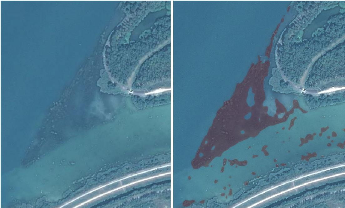
Figure 3 : Résultat de la prédiction du modèle IA en cours de test sur le Rhône : image satellitaire PLEIADE (à gauche) et délimitation des surfaces de macrophytes prédites par le modèle entraîné, avec ici un seuil de probabilité de présence de macrophytes fixé à 95% (à droite) – source EDF
