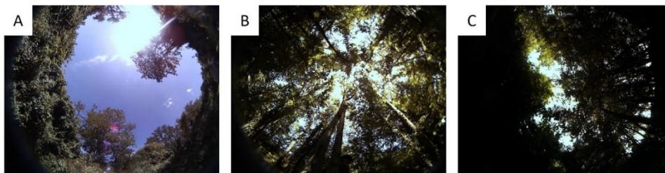
Figure 1 : Visualisation des prises de vues hémisphériques (lentille fisheye) via le CI-110 Plant Canopy Imager, en (A) AY02 (LAI = 43,9 %), en (B) AY04 (LAI = 80,8 %) et en (C) SE01 (LAI = 86,1 %).
