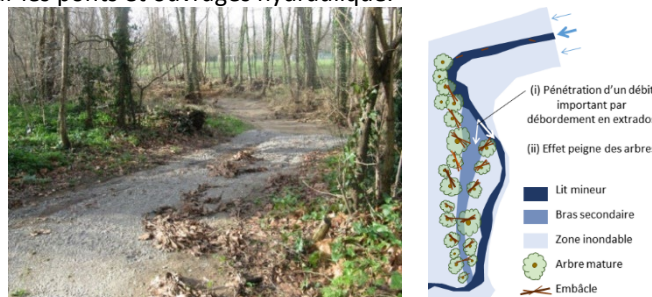
Figure 3 : Photographie du bras secondaire (source : SMAC) et cartographie synthétique du site
