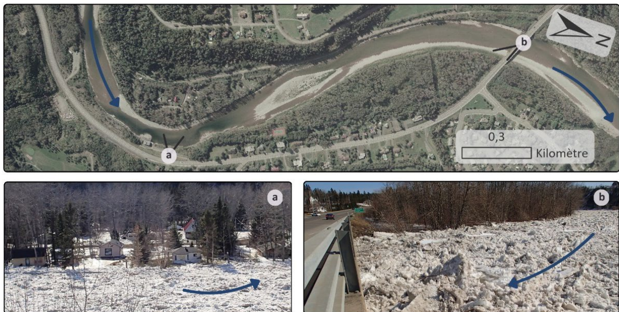
Figure 1. Embâcle sur la rivière Matane (Québec, Canada) en avril 2014 selon deux prises de vue, de l'amont vers l'aval. La prise de vue (a) illustre des habitations impactées par cet embâcle ; la prise de vue (b) montre son impact sur un pont et une route.
